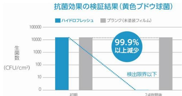
【試験方法】JIS Z 2801(フィルム密着法)。試験片の表面に試験菌
