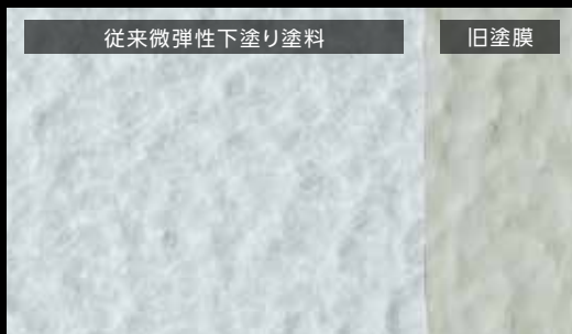
従来微弾性下塗り塗料(薄塗り塗装)
