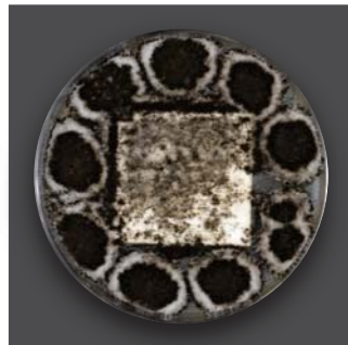
アクリル樹脂塗料 防カビ・防藻性を有さない一般塗料
