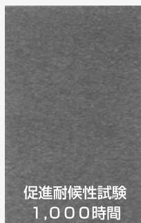
アスファルト成分のブリード防止+アクリルシリコン効果
