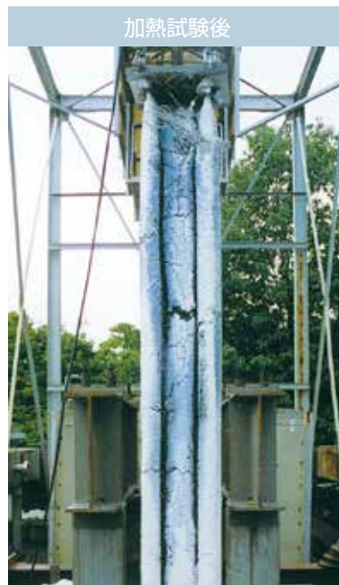
柱（H-300×300）の荷重加熱試験（試験機関：日本建築総合試験所）
