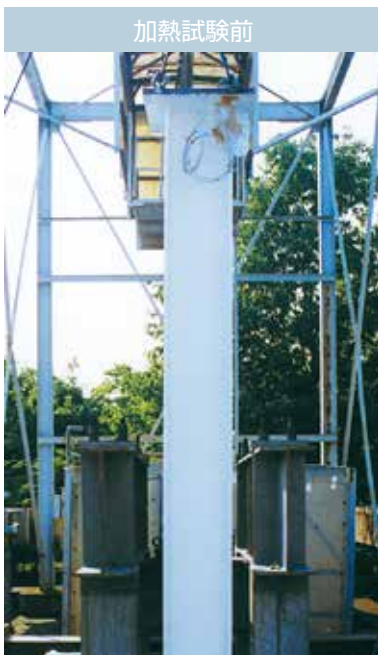
柱（H-300×300）の荷重加熱試験（試験機関：日本建築総合試験所）
